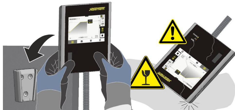
Fig. 33: Colocar o controlador no suporte que se encontra no forno (semelhante à figura)
