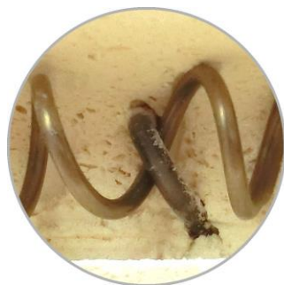
73 pav. įkalti tvirtinimo elementus į izoliacines plytas (panašu į paveikslėlio vaizdą)
