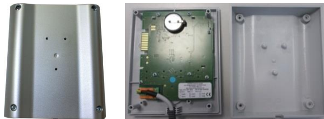
Fig. 11: Sustitución de un controlador (figura análoga)
