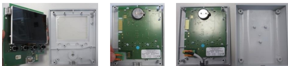
Fig. 15: Montaje de la placa del controlador – parte 2 (figura análoga)
