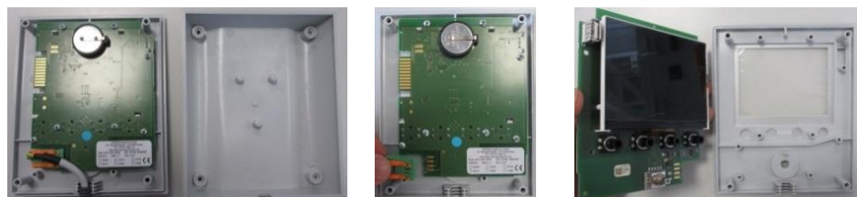
Fig. 13: Desmontaje de la placa del controlador – parte 2 (figura análoga)
