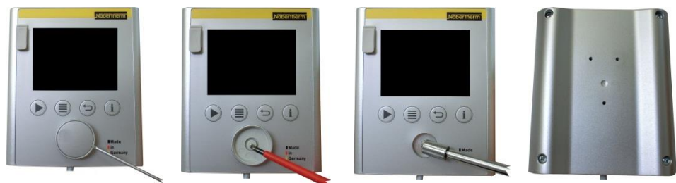
Fig. 12: Desmontaje de la placa del controlador – parte 1 (figura análoga)
