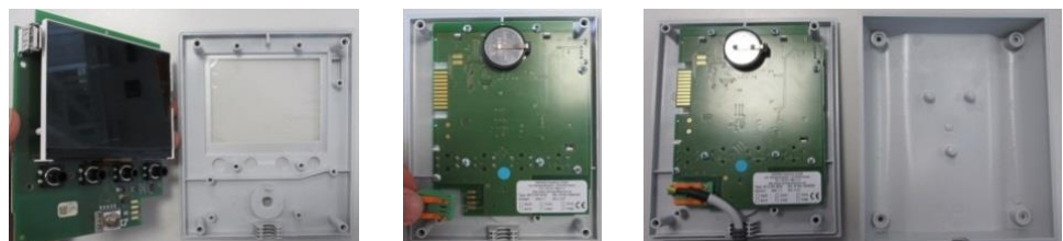
Fig. 15: Montere styringens kretskort – del 2 (illustrasjon – kan avvike fra faktiske forhold)
