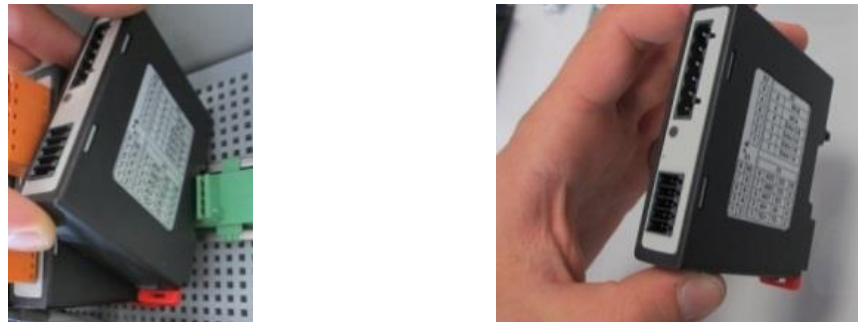
Fig. 18: Demontere styringsmoduler – del 2 (illustrasjon – kan avvike fra faktiske forhold)
