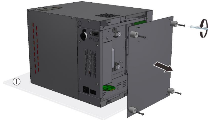
Fig. 54: Demontarea plăcii de podea - model LHT 01/17 D (figură similară)
