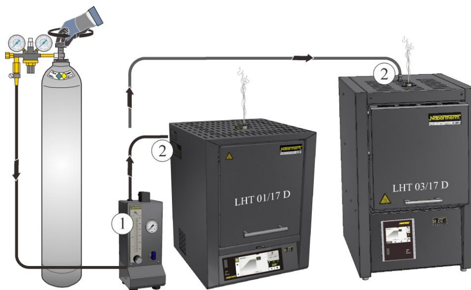
Fig. 63: Tilkobling på gassforsyningssystemet (illustrasjonen kan avvike)
