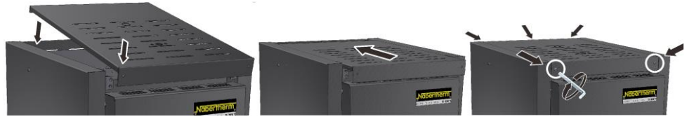
Fig. 39: Montering av dekslet – modell LHT 03/17 D (illustrasjonen kan avvike)
