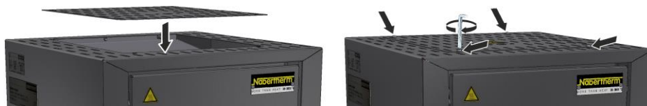
Fig. 50: Montering av dekslet – modell LHT 01/17 D (illustrasjonen kan avvike)
