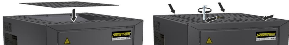
Fig. 19: Montering av dekslet – modell LHT 01/17 D (illustrasjonen kan avvike)
