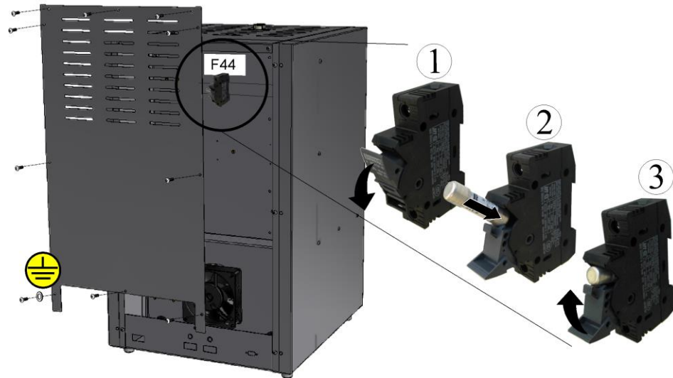
Fig. 60 : Démontage du cache du système de distribution (figure similaire) Desserrer les vis au dos et les ranger en lieu sûr pour une réutilisation ultérieure.
