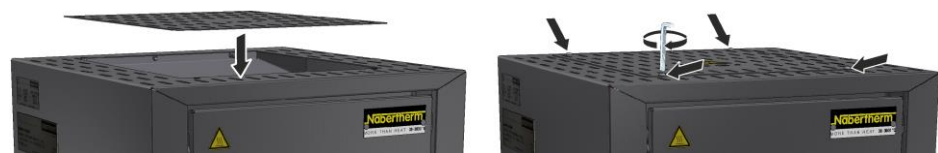
Afb. 19: Montage van de afdekking model LHT 01/17 D (afbeelding vergelijkbaar)
