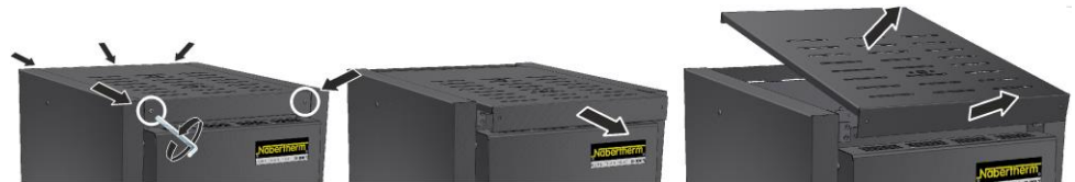
Afb. 45: Afdekking demonteren model LHT 03/17 D (afbeelding vergelijkbaar)
