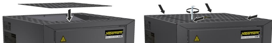
Afb. 51: Montage van de afdekking model LHT 01/17 D (afbeelding vergelijkbaar)
