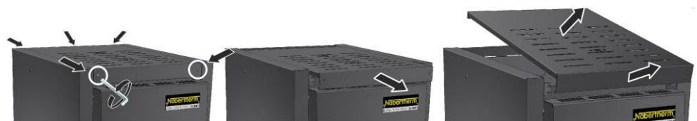
Afb. 37: Afdekking demonteren model LHT 03/17 D (afbeelding vergelijkbaar)
