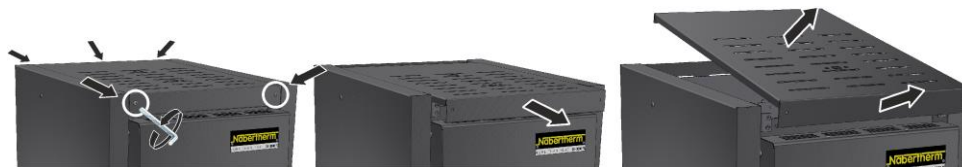
Afb. 56: Afdekking demonteren model LHT 03/17 D (afbeelding vergelijkbaar)
