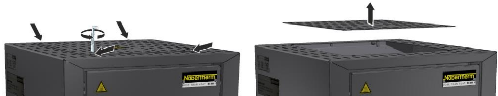
Afb. 17: Afdekking demonteren model LHT 01/17 D (afbeelding vergelijkbaar)
