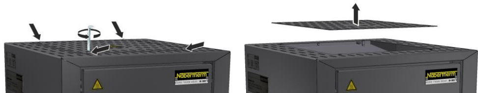
Afb. 44: Afdekking demonteren model LHT 01/17 D (afbeelding vergelijkbaar)
