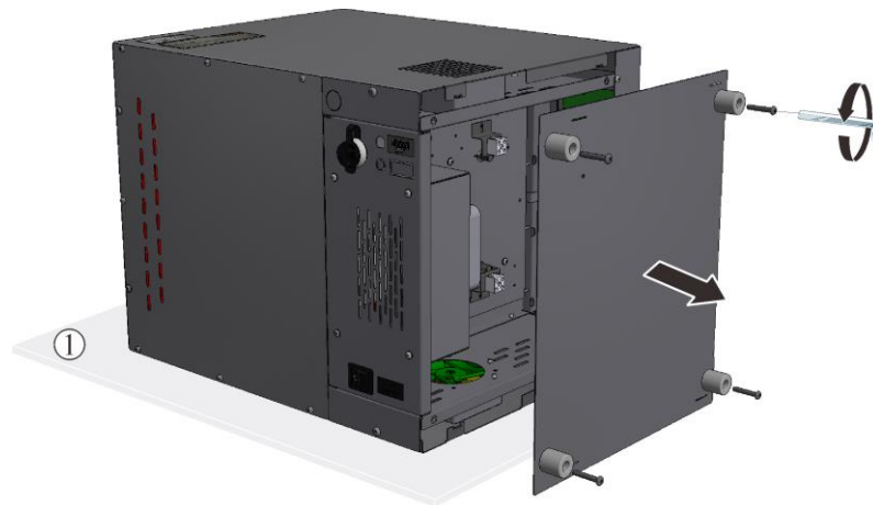
Afb. 54: Demontage van de bodemplaat - model LHT 01/17 D (afbeelding vergelijkbaar)
