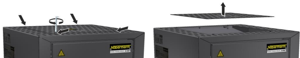
Afb. 36: Afdekking demonteren model LHT 01/17 D (afbeelding vergelijkbaar)
