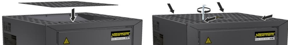
Afb. 39: Montage van de afdekking model LHT 01/17 D (afbeelding vergelijkbaar)
