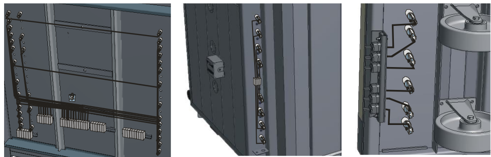
Fig. 95: Exemplu: Dispunerea elementelor de încălzire (similar cu figura)
