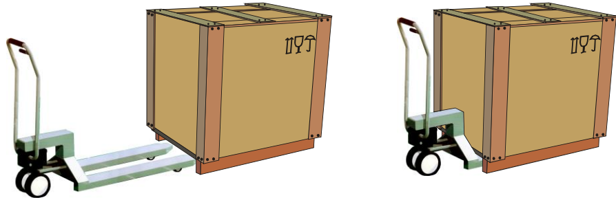
Abb. 14: Hubwagen wird vollständig unter das Transportgestell geschoben
