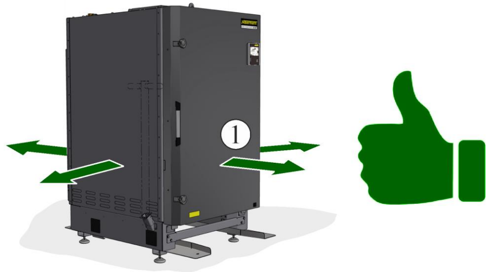
Abb. 28: Ofen absetzen und positionieren (Abbildung ähnlich)
