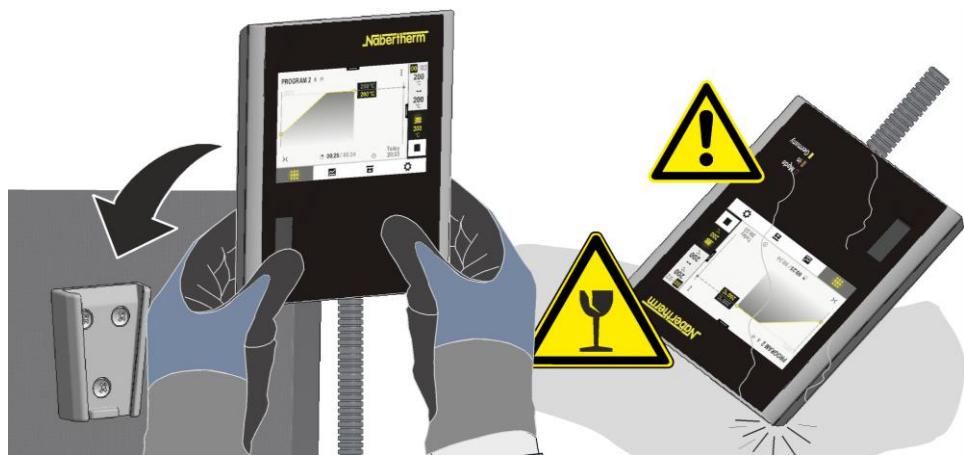
Abb. 71: Controller in den am Ofen befindlichen Halter einsetzen (Abbildung ähnlich)
