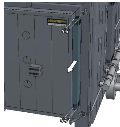
Beispiel: Abdeckung für Heizelementanschlüsse in der Tür
