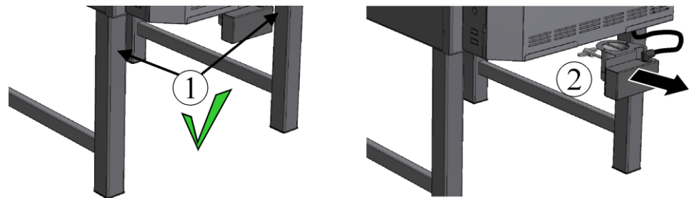
Abb. 52: Zuluftklappe aus der Halterung herausziehen (Abbildung ähnlich)
