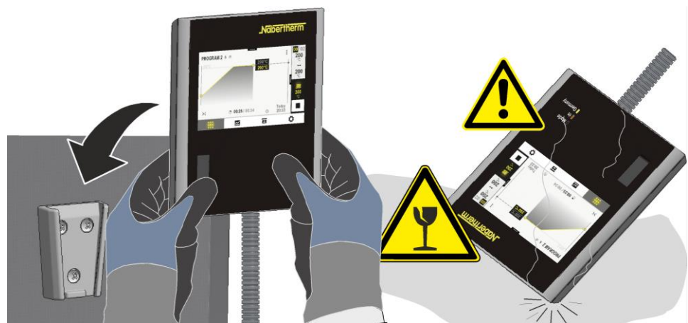
Abb. 55: Controller in den am Ofen befindlichen Halter einsetzen (Abbildung ähnlich)
