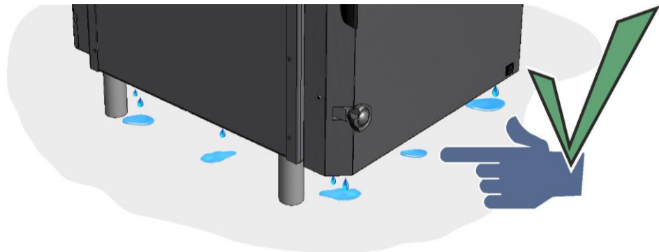
Abb. 67: Kondensatansammlungen während der ersten Brände (Abbildung ähnlich)
