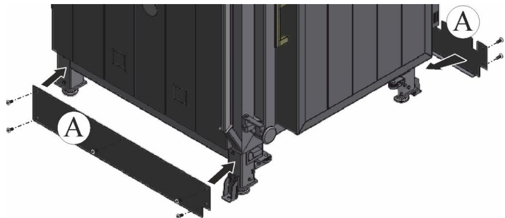
Abb. 46: Montage der Seitenbleche (Abbildung ähnlich)
