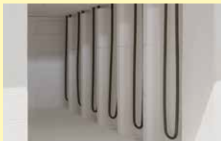
加热元件保护装置作为额外配置，用于避免在装料和卸料时出现机械损坏
