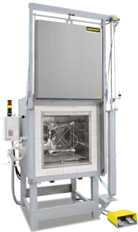
用来测量温度均匀性的测量架
