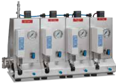
带质量流量控制器的气体面板
