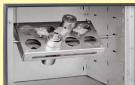
电动旋转装置作为附加配置（这里采用用于PARR容器的客户定制平台）
