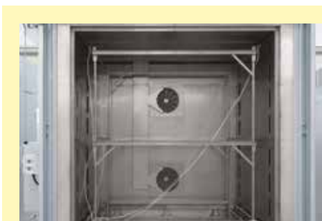
可插入式测试架用于N 7920/45 HAS型空气循环箱式炉的测试
