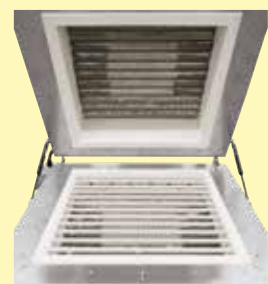
炉底和炉顶加热，两区控制
