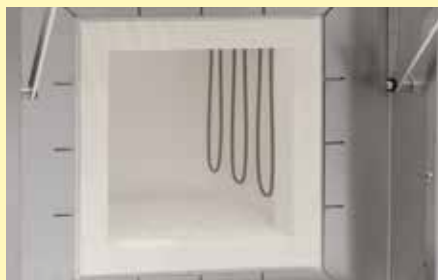
炉膛采用优质纤维材料，二硅化钼制成的加热元件位于两侧
