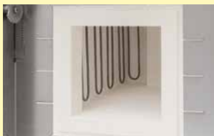
炉膛内的高温加热装置
