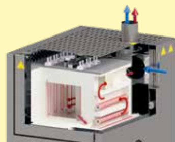
组合炉LHT 08/17 B0空气导入示意图
