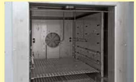
内膛有插入板、热电偶和压力监控
