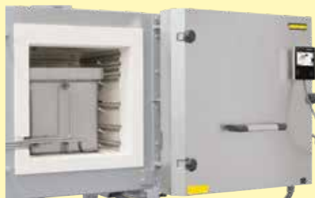
Puerta de desplazamiento paralelo para abrir en estado caliente
