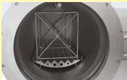
Superficie de carga y bastidor de medición TUS para horno de retorta NR 20/11
