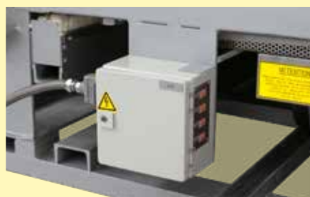
Conexión de termopares de cargas con unión enchufable
