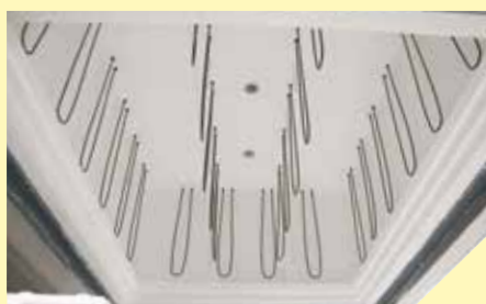
Calentamiento desde todos los lados y entre la pila para optimizar la homogeneidad de la temperatura
