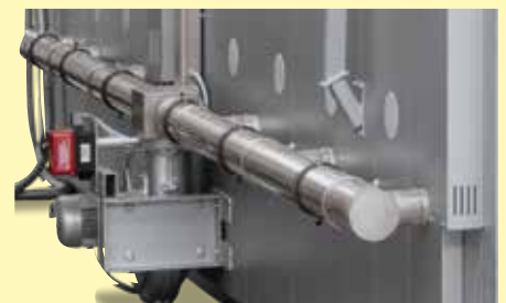
Sistema de refrigeración con ventilador de aire fresco
