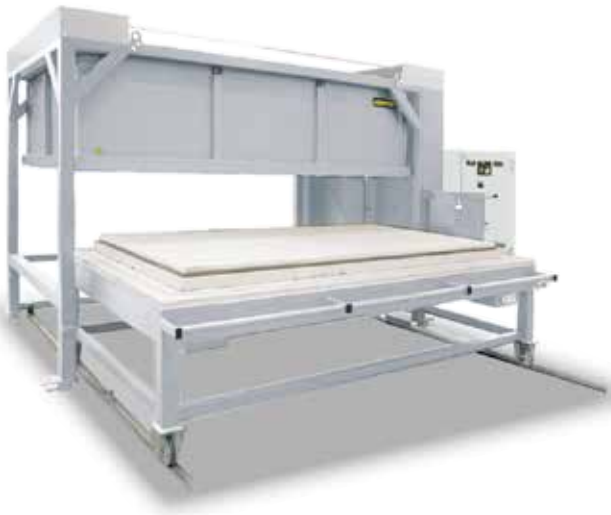
Horno de campana con mesa HG 1196/S con calentamiento de campana y mesa; calentamiento de mesa desconectable para trabajos de fusión.
