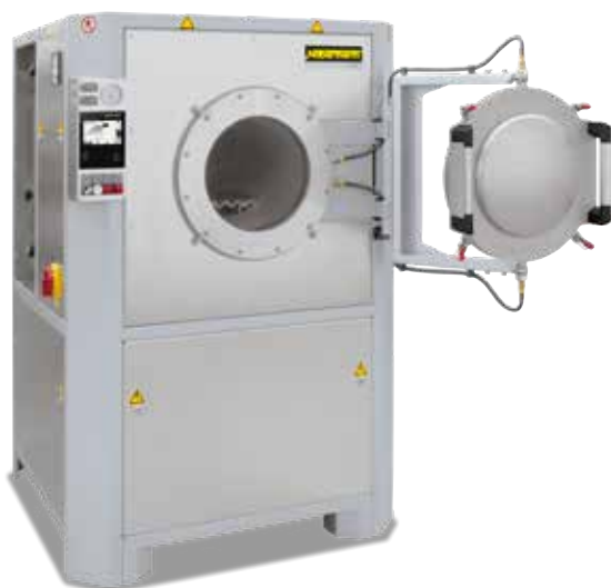
Horno de retorta NR 20/11 con puerta giratoria paralela
