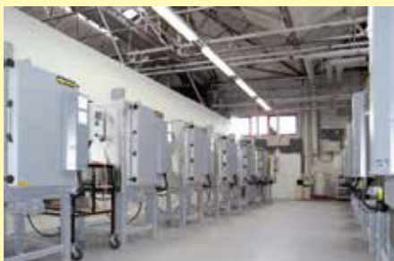
Horno de cámara N 200/14 para el sinterizado de semiconductores
