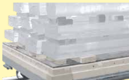
Horno de vagoneta para templar las barras de cuarzo.
