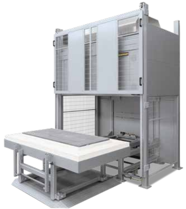
Horno con elevador inferior HF 1220/LBS con aislamiento de fibra, valla de seguridad a modo de protección en la zona de riesgo y mesa de extracción manual para facilitar la carga y descarga
