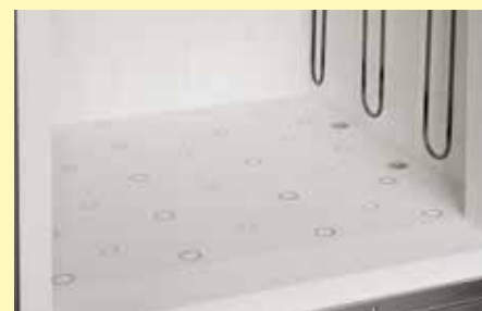
A partir del horno de alta temperatura HT 16/16 se incluye como característica estándar el suelo reforzado para aliviar la carga del aislamiento de fibra
