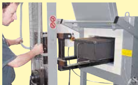
Trabajo con caja de inyección de gas para atmósferas de gas de protección con ayuda de un carro de carga
