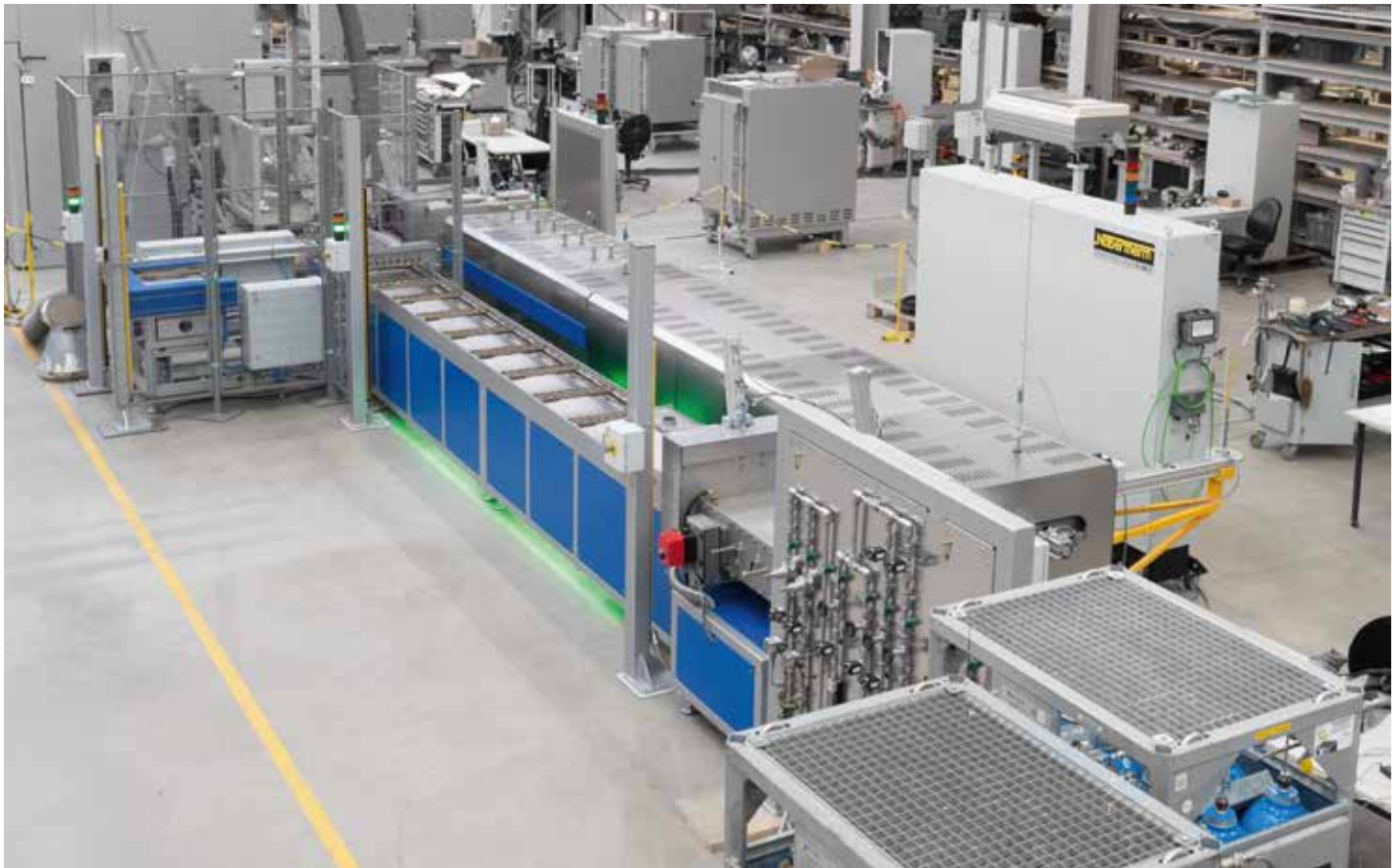
Instalación de horno continua D 520/2600/55-04 S para la sinterización de revestimientos de teflón con gas protector
