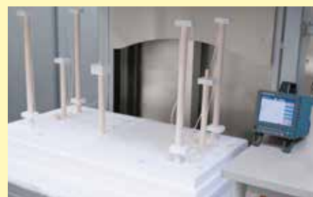
Dispositivo de medición para determinar la homogeneidad de la temperatura en un horno con elevador inferior de alta temperatura con dispositivo de elevación inferior
