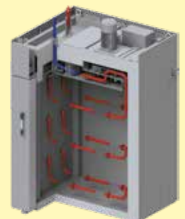
Desviación del punto de medición de temperatura media en el espacio útil de la cámara es de p.ej. \pm 3 K
